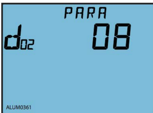
Fig.3-68 DO2 alarm output item setting
