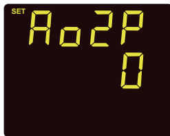
Fig 3-22 AO2 Parameter Setting
